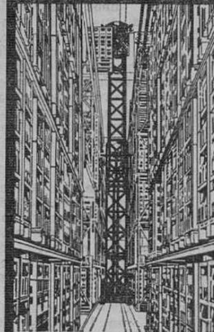
Quando las necesidades exigen una productividad óptima del espacio y del equipo, las carretillas torre de Lansing Bagnall son la respuesta más adecuada para obtener un almacenamiento super compacto, permitiendo obtener alturas de almacenamiento de hasta 12,5 metros con preselección automática de posición vertical y horizontal.
