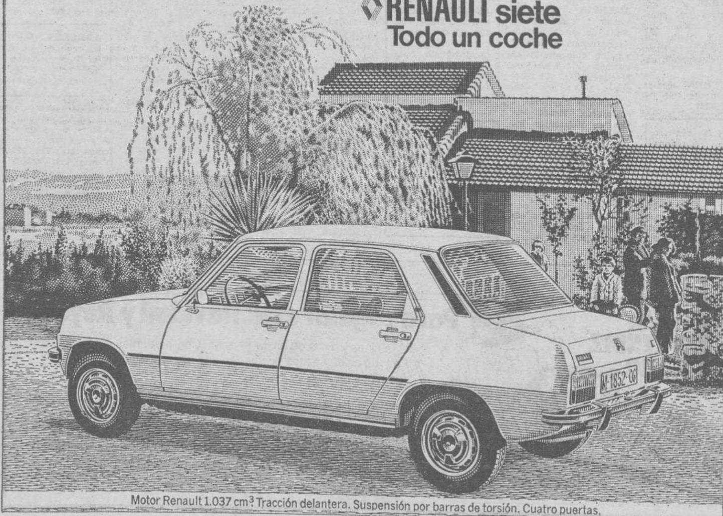
Motor Renault 1.037 cm<sup>3</sup> Tracción delantera. Suspensión por barras de torsión. Cuatro puertas.
