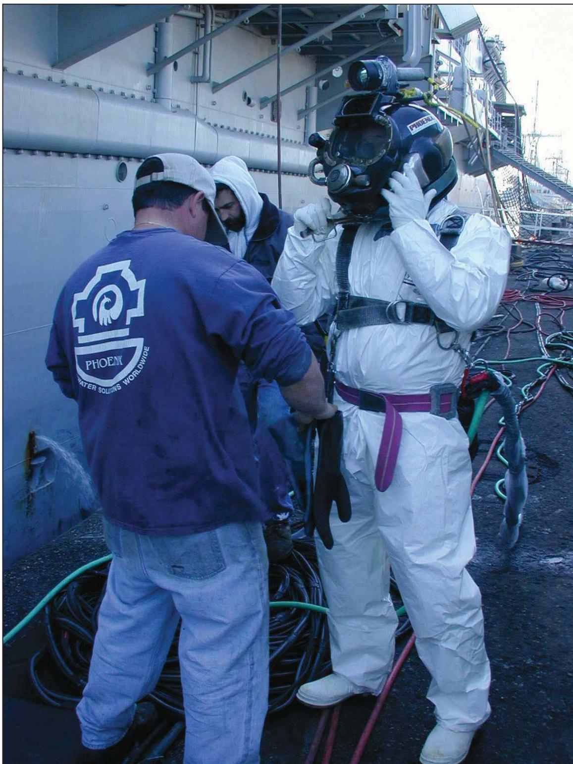
*Fig.81 Imágenes de apoyo. Equipo de soldadura submarina*
