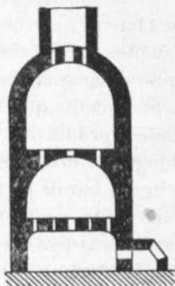
Figura 178.—Horno para la cocción de loza común.
