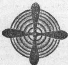
(Fig. 10.) — Figura de interferencia producida por un mineral uniáxico
