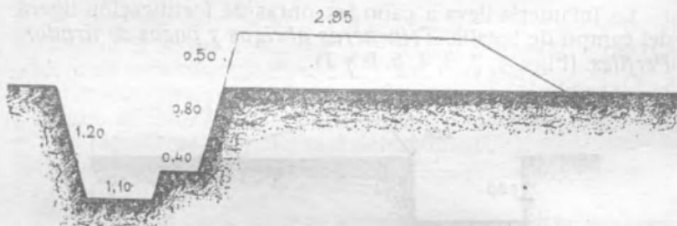
Trincherá abrigo de perfil reforzado.—Fig. 4
