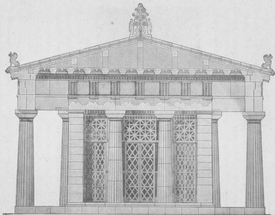
Fig. 19.—Esquema de un templo dórico (de Afaia, en Egina). Según Furtwängler
