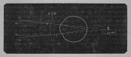
FIGURA 155 - Corrección de la hipermetropia con un vidrio convexo.
