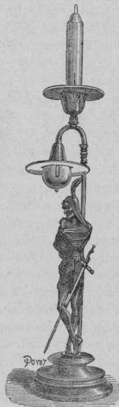
Fig. 3. Candelero mixto para bujía y para lámpara eléctrica de M. Trouvé.
