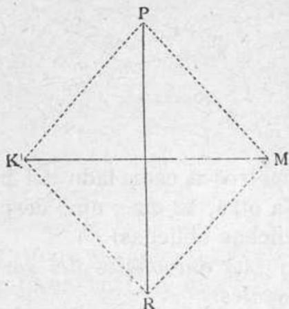
21. *Construir un rombo que tenga una diagonal de 20 centímetros y otra de 26 cm.*
