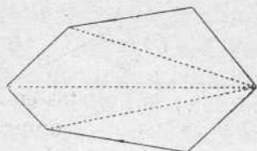
Polígono irregular descompuesto en triángulos
