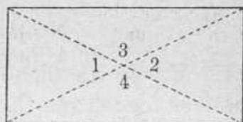
Los triángulos 1 y 2 tienen sus tres ángulos agudos: triángulos *acutángulos*. Los triángulos 3 y 4 tienen cada uno un ángulo obtuso: triángulos *obtusángulos*
