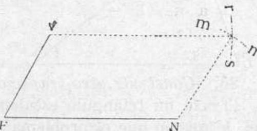
agudo VFN, por ejemplo, que tenga un lado de 12 centímetros (V F) y otro de 20 centímetros (F N); desde el extremo V, con una abertura de compás de 20 centímetros, traza un arco (*r s*), y desde el extremo N, con una abertura de 12 cm., traza el arco *m n*. Une, después, el punto en que se corten los arcos con los lados del ángulo formado).
