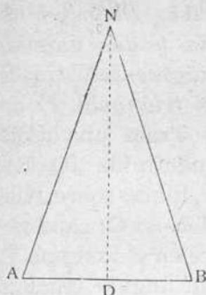
(Traza una recta de 20 cm. (A B); levanta, en su mitad, una perpendicular de 30 centímetros (D N); y une, con sus dos extremos (A N y N B).
