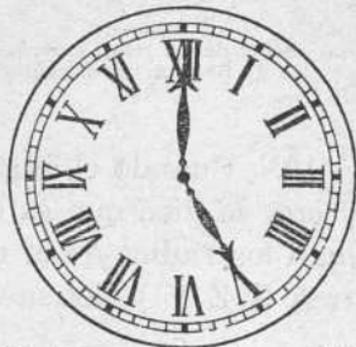
Si la línea curva que forma el límite o borde de la esfera del reloj se dividiese en 360 partes iguales, cada una de esas partes sería un grado
