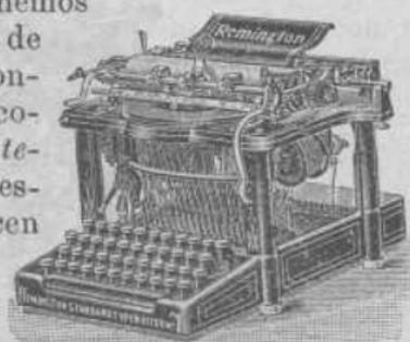
Fig. 5.—Semitipa o máquina de teclado simple (Remington).
