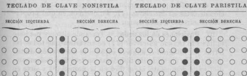
Figs. 61 y 62.—División del teclado; en la clave nonistila, la *línea divisoria* se representa por medio de teclas negras (hilera central); y en la clave paristila, por una línea de puntos entre las dos hileras prodivisas, señaladas también con teclas negras.
