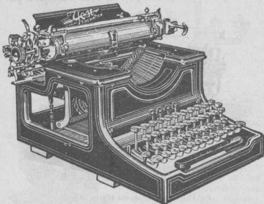
Fig. 15.—Tampotipa o máquina de tampón. (Yost núm. 10).
