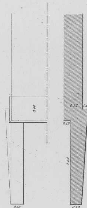
CUBICACION de las embocaduras en la estension de un metro lineal por cada lado.
