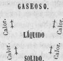
La direccion de las flechas indica, subiendo por un lado; la absorcion de calor y el cambio de estado á partir del sólido, y por otra parte, el desprendimiento de este calor latente y la trasformacion al estado primitivo.
