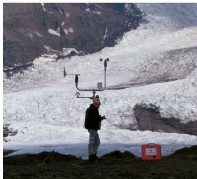
Instalando una estación meteorológica en el Kvíarjökull
