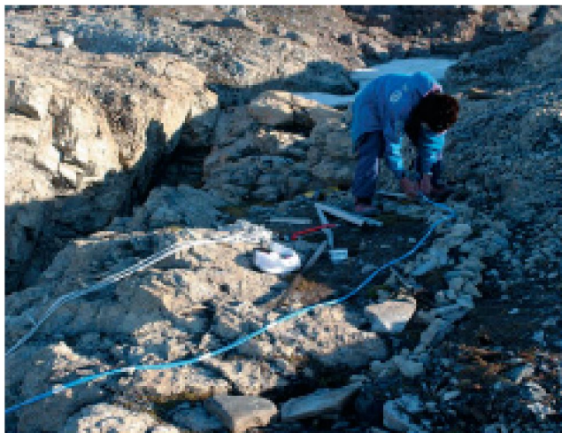
Protegiendo el cable de las sondas instaladas
