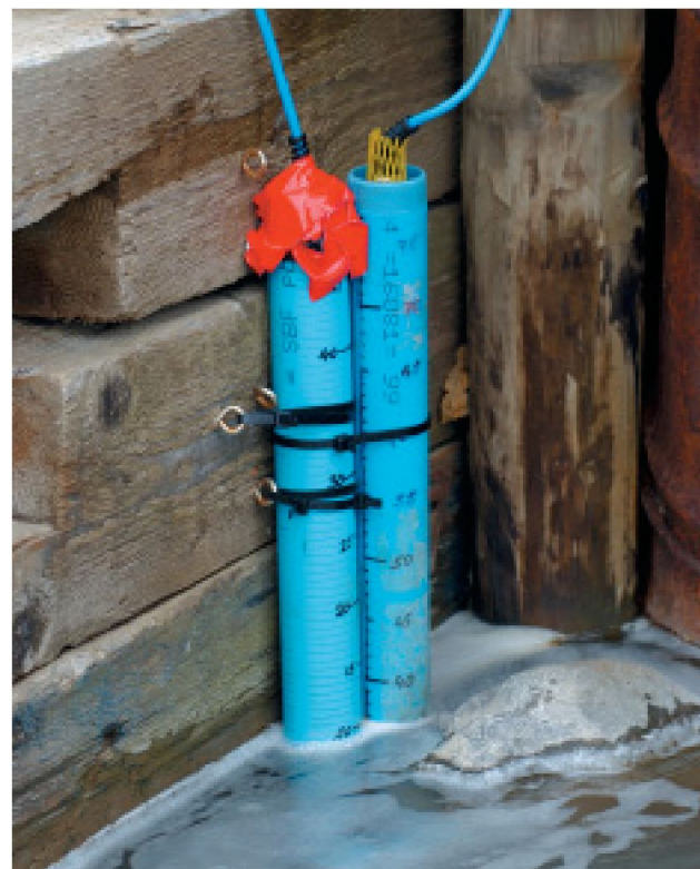
Sonda multiparamétrica en la estación BCAA
