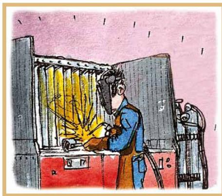
los gases no contaminen el aire respirado. Las piezas no deben ser demasiado grandes para no cubrir completamente el conducto e impedir el efecto de extracción.
