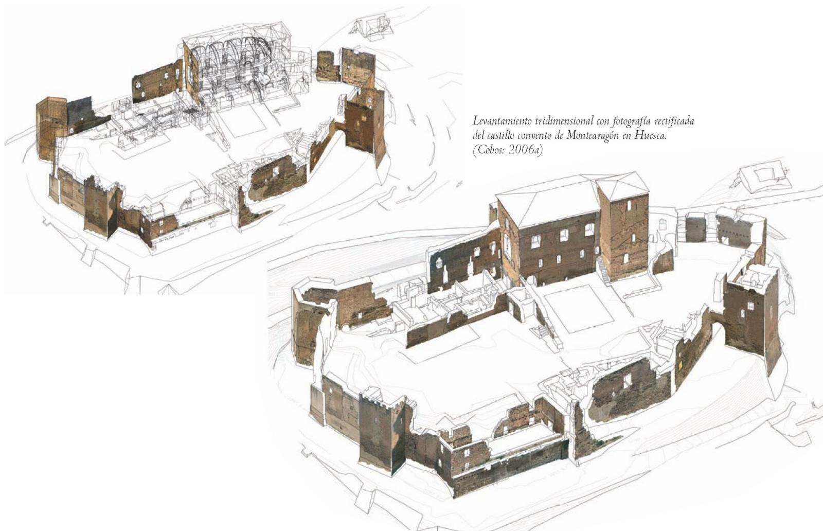
*Levantamiento tridimensional con fotografía rectificad
