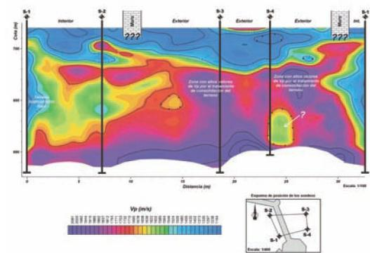
Esquema de consolidación del borde de ladera y tomografía sísmica realizada a partir de sondeos físicos para verificar el grado de consolidación y presencia de galerías en el castillo de Monteagudo de las Vicarías (Soria). Junta de Castilla y León, Obras de Emergencia, Fernando Cobos. Estudio de arquitectura
