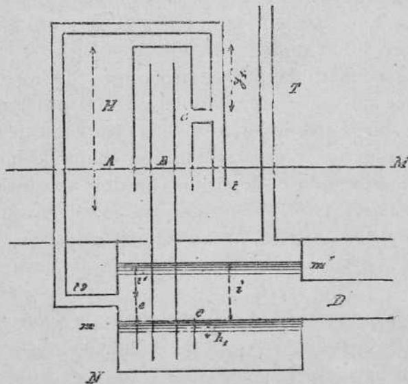
Uno T que pone en comunicación la cámara N con la atmósfera y otro t,  $t_1$ ,  $t_2$ , dispuesto como indica la figura y cuyo orificio inferior termina á una distancia e sobre la cámara de expansión C.
