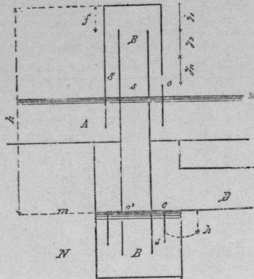
Consiste el aparato en una campana A colocada en el depósito, que á cierta altura lleva un orificio o y cuyos bordes inferiores no llegan al fondo del depósito.
