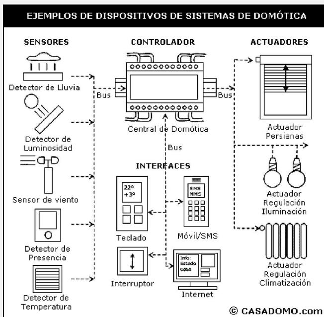
ILUSTRACIÓN 6 - ESTRUCTURA DE UN SISTEMA DOMÓTICO O INMÓTICO
