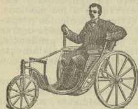
Coché movido por medio de dos palancas
