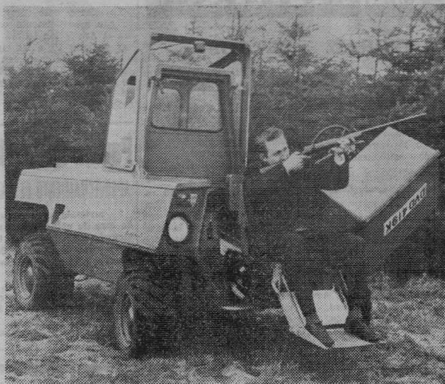
El Laboratorio Nacional de Ingeniería de Gran Bretaña ha diseñado este vehículo, que fabrica ya una compañía escocesa, que permite a los agricultores que se hallan impedidos recorrer sus tierras, así como a los cazadores con los mismos defectos físicos practicar aun en terrenos escabrosos. El coche, denominado "Amnel Wildcat", puede subir y bajar con toda seguridad pendientes de 40 grados. El conductor puede trasladarse sin ayuda desde su silla de ruedas a él, desplazando a un lado el volante para dejar libre la parte frontal. También puede situar el asiento fuera del vehículo ajustando hacia adelante la silla que se eleva manualmente, levantando o desplazando la cabina del vehículo como vemos en esta fotografía. — (Foto FIEL).
