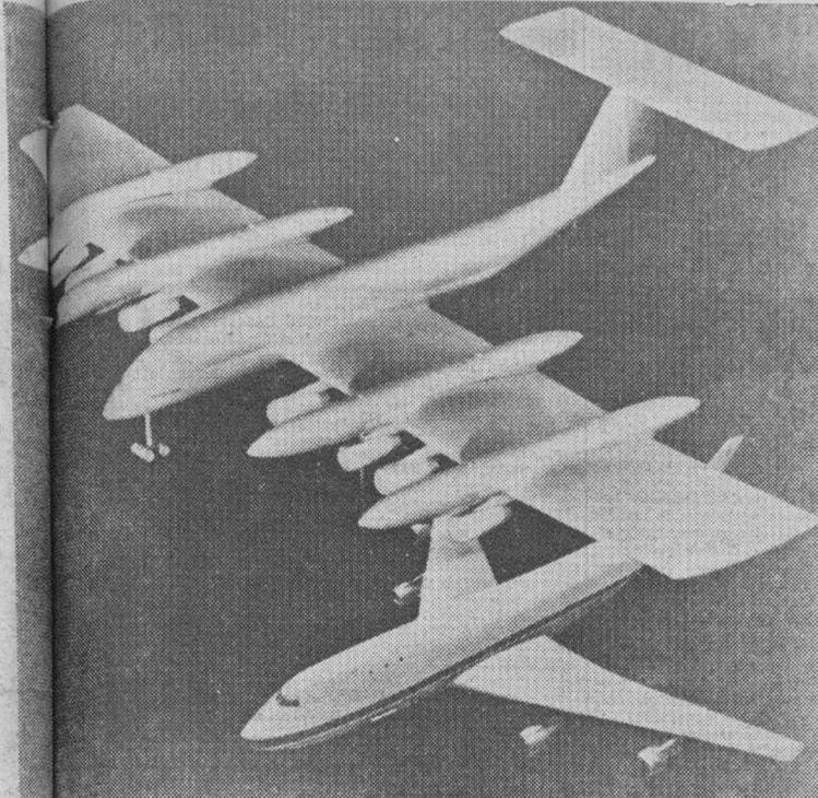
El «Jumbo» diseñado por la firma Boeing, que se ve arriba en la foto, podría transportar una carga 24 veces mayor que la que pueden llevar los «Jumbo Jet» actuales, uno de los cuales aparece debajo en la foto a efectos comparativos. — (Foto EFE).
