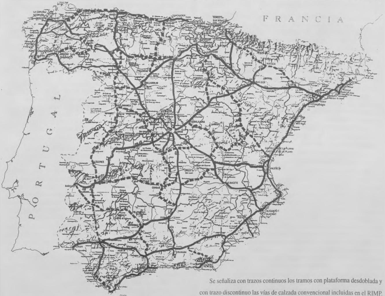
Se señala con trazos continuos los tramos con plataforma desdoblada y con trazo discontinuo las vías de calzada convencional incluidas en el RIMP.
