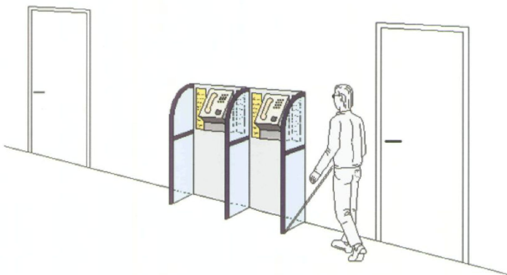
Mobiliario prolongado hasta el suelo
