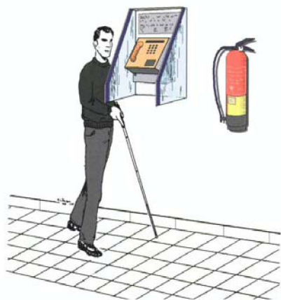
Mobiliario adosado a pared de forma incorrecta
