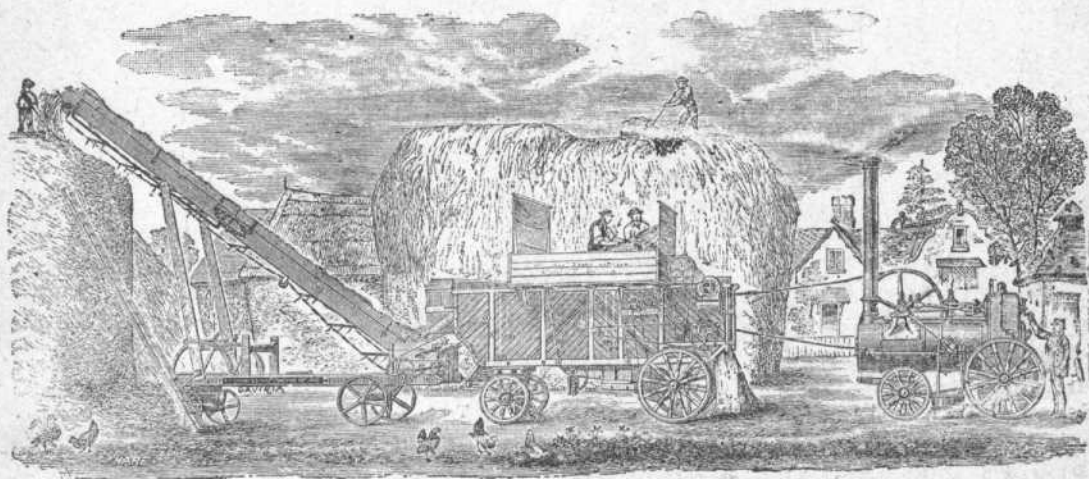
GRAB. 78.—Trilladora de vapor de Marhal, funcionando todas sus partes.
