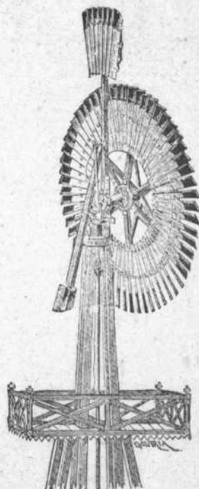
GRAB. 68.—Motor de alambre para bombas aspirantes.
