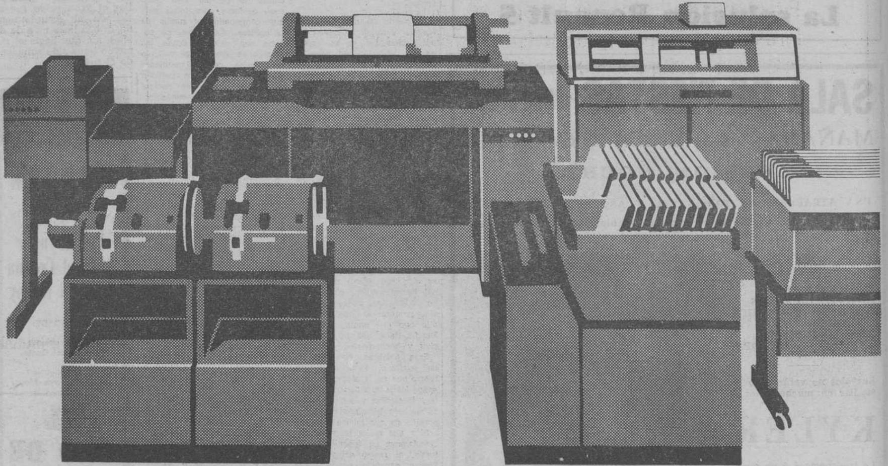
**Auditronic 770:** Sistema modular integrado por una unidad central de tratamiento y unidades conectables de input-output para cinta magnética, cinta perforada, edge card, ficha perforada y ficha contable con banda magnética.
