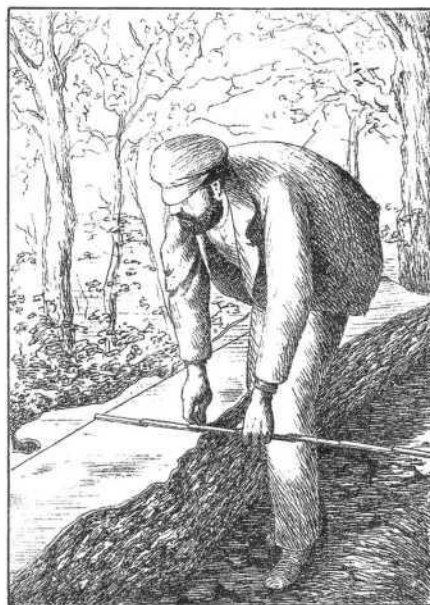
Fig. 5. Gruar un árbol á esquina viva (de fotografía).
