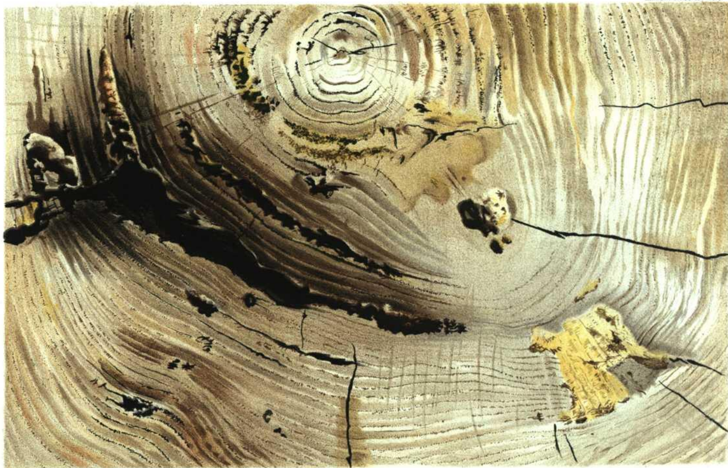
Fig. 1. Madera de roble con griseta amarilla y pudrición negra. Monte de Cabezon. Tamaño natural.
