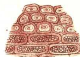
Fig. 5. Acción del hidrógeno ferrocianato de potasa en los tejidos del haya inyectada con sulfato de cobre.
