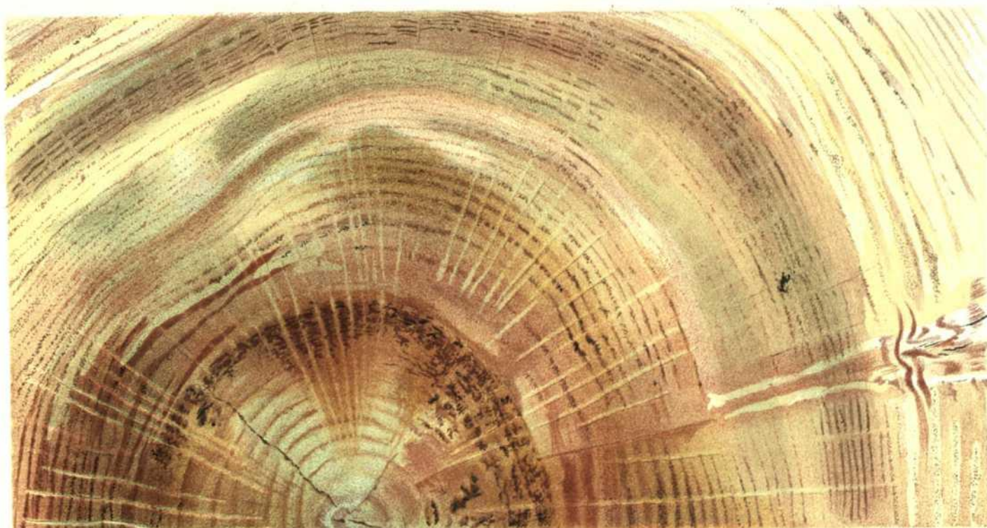
F. Waller Chromo Lith. 15, Hatton Garden, London. Fig. 2. Madera con heladura almadada. Monte de Uceda. Tamaño natural.
