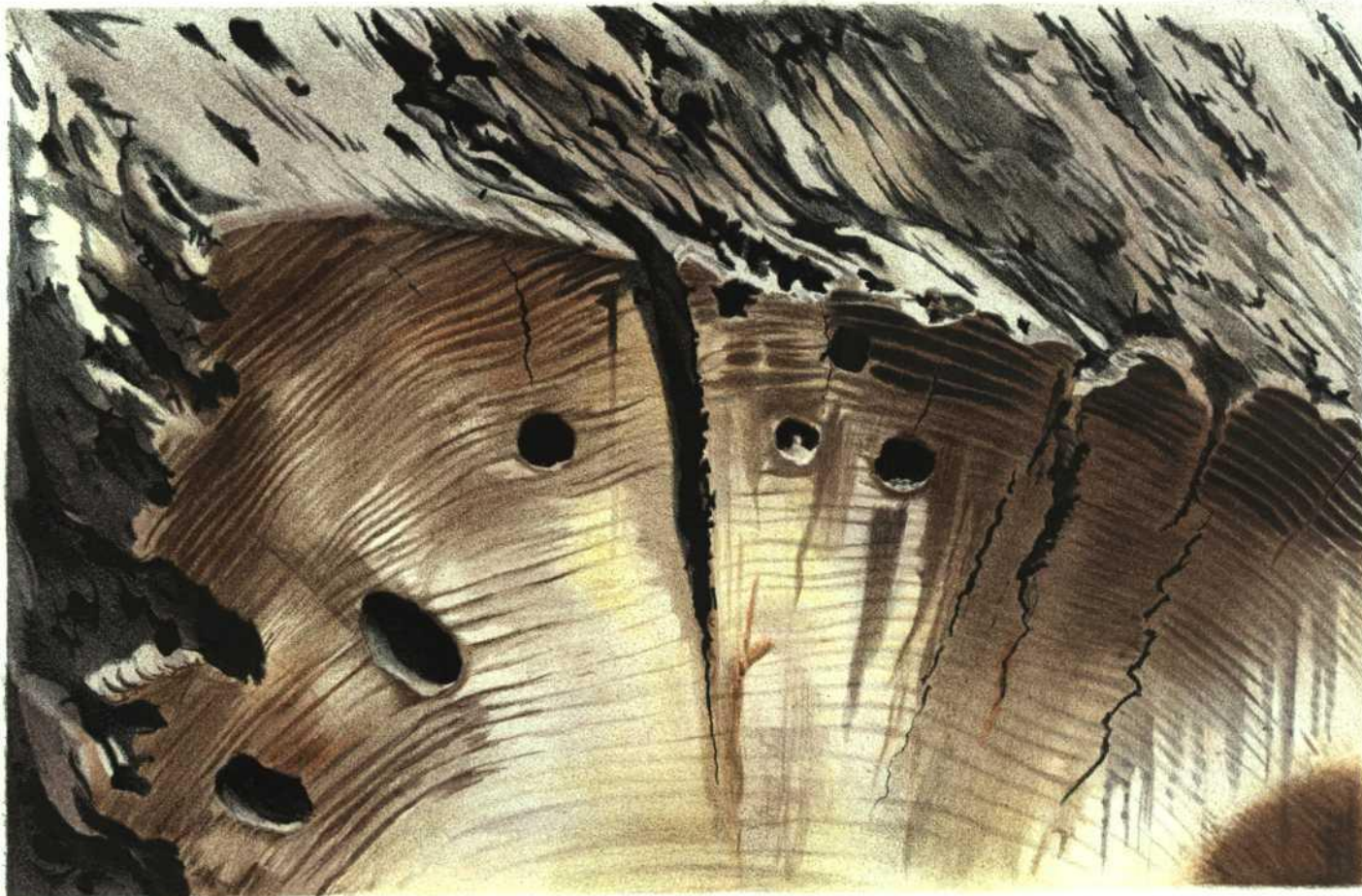
Fig. 1. Madera de roble atacado por la Broma. Tamaño natural.
