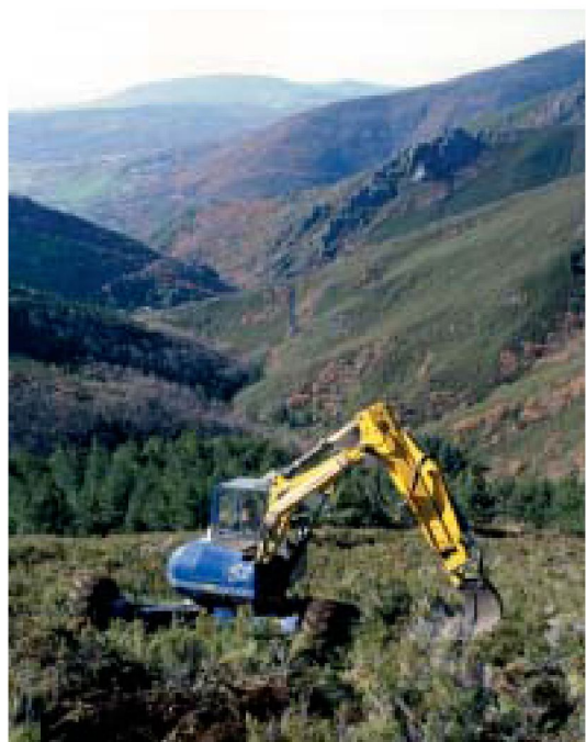
Repoblación con retroaraña en Torre del Bierzo.
